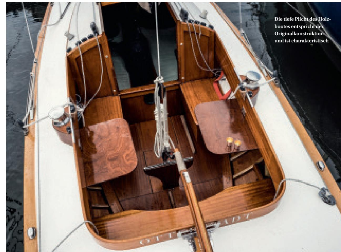
Die tiefe Plicht des Holzbootes entspricht der Originalkonstruktion und ist charakteristisch
